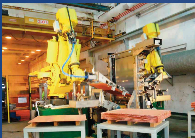
Выше: Роботизированный съем на рафинировочном заводе Nikkelverk.
