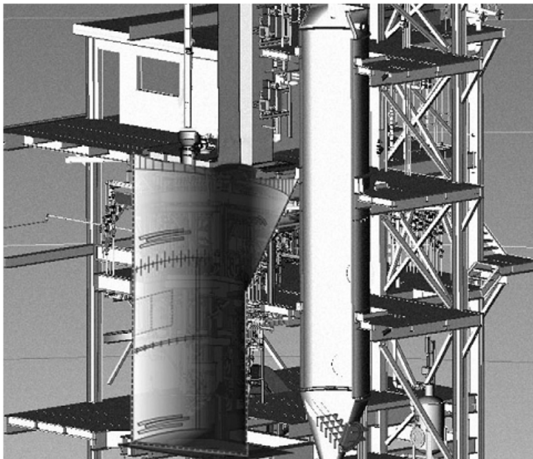
Рисунок 4. Конструкция печи ISACONVERT™ в разрезе.
